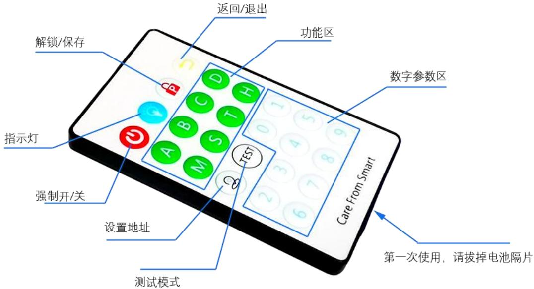
**注：在进行遥控器操作前，需先按五次“
