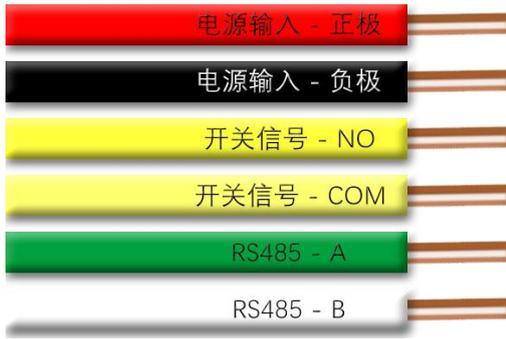
QZX352 产品 RS485 功能接线方式，一条总线可连接多个设备通讯，同一总线数量较多或通讯距离较长，数据线应采用屏蔽双绞线并在 A/B 间接上 120~150 欧姆匹配电阻。
