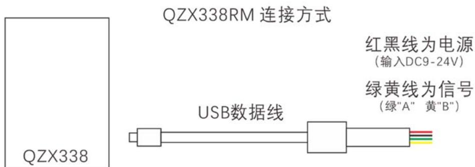
QZX338RM (RS85) 接线方式, 一条总线可连接多个设备通讯, 同一总线数量较多或通讯距离较长, 数据线应采用屏蔽双绞线和在 A/B 线终端接上 120 欧姆匹配电阻。
